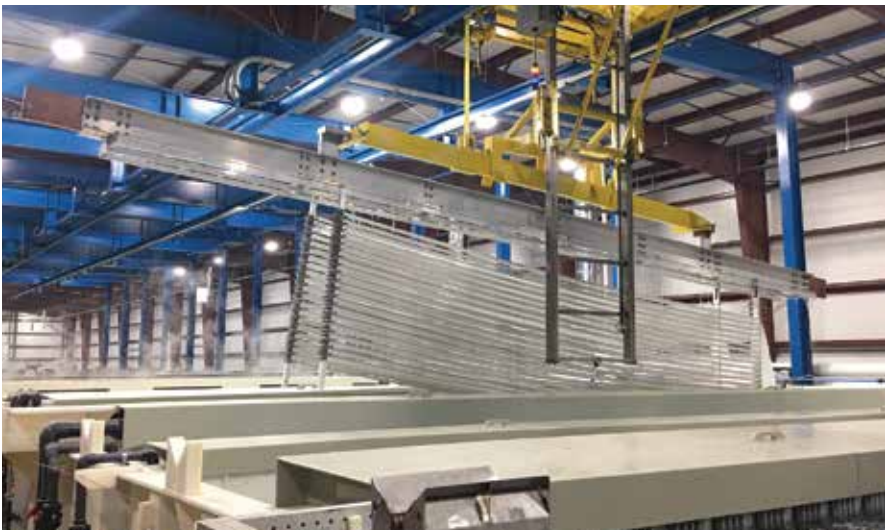
Dây chuyền Anode
